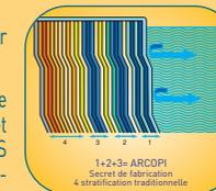
Le procédé d'application et de traitement ARCOPI® est un procédé unique dans la mise en œuvre des stratifiés polyester ressortant d'une longue expérience dans les industries de la piscine et du nautisme.
